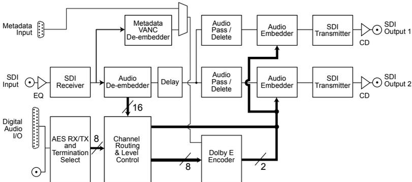
Fig 1-4: RB-VHEDD8 System Block Diagram.
